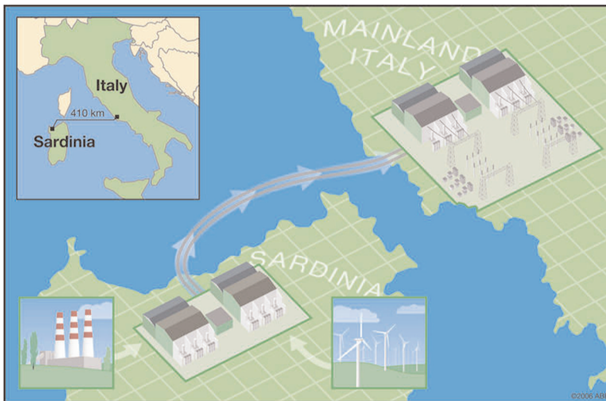
Diagramma dell'interconnessione in HvdC Sardegna - Penisola Italiana
